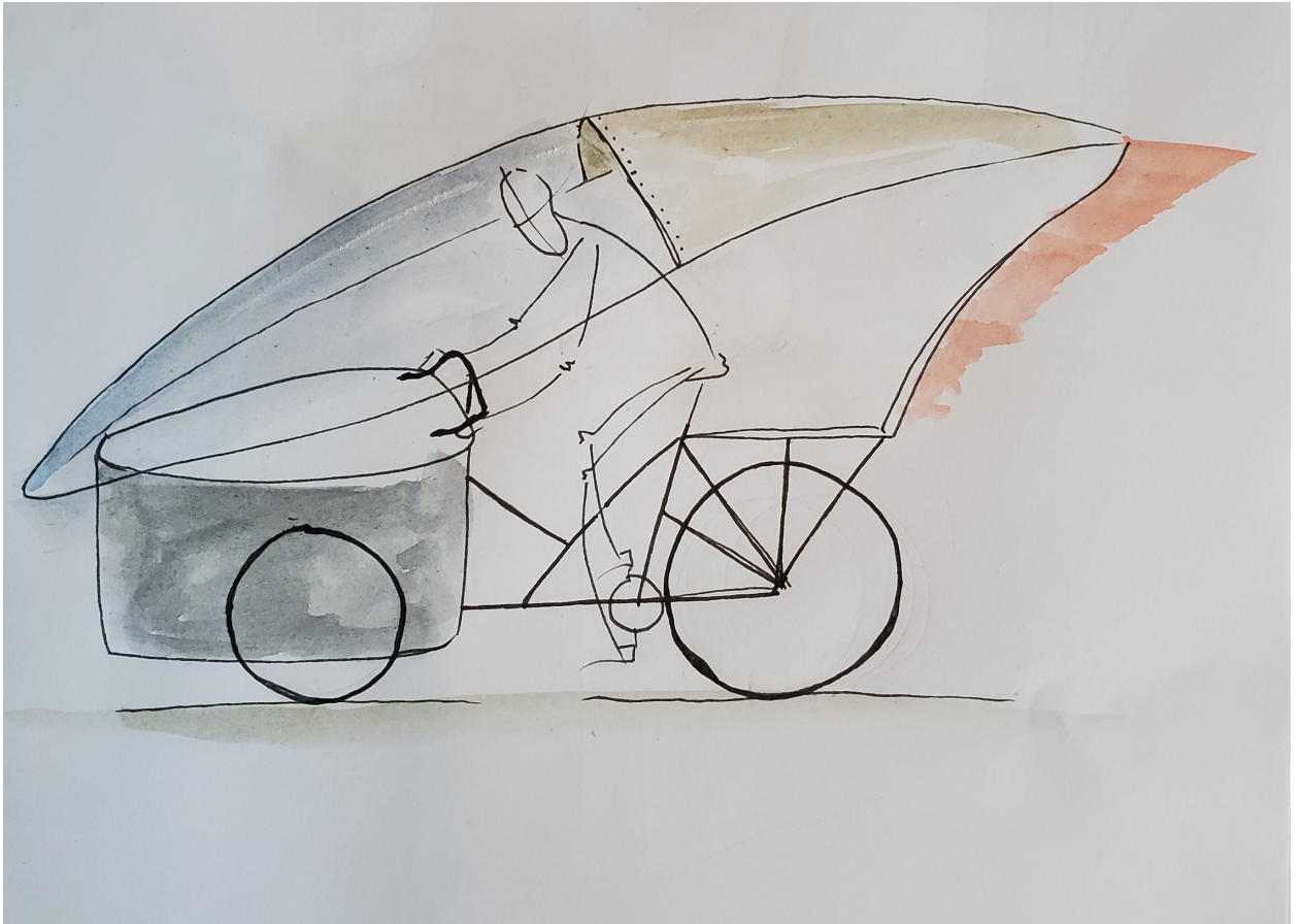
Esquisse du carénage « Racer » / mix de polycarbonate et de Kairlin. Crédit : Clément Chabot
