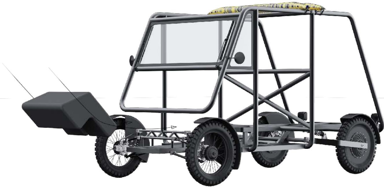
Montage du pare-choc avant
