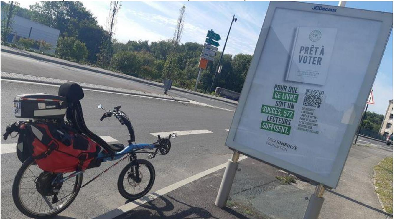
Mais il est possible d'utiliser de la bâche PVC 650g/m<sup>2</sup> avec des soudures utilisant un fer à air chaud de 350°C. il faut 2 heures pour réaliser une sacoche (découpe, soudure, vissage...) Donc, nous nous sommes lancés dans un premier temps dans la fabrication de sacoche classique. La réduction de la masse est de 35% avec un volume double par rapport à la marque Ortlieb en utilisant du coroplast en interne pour améliorer la rigidité.
