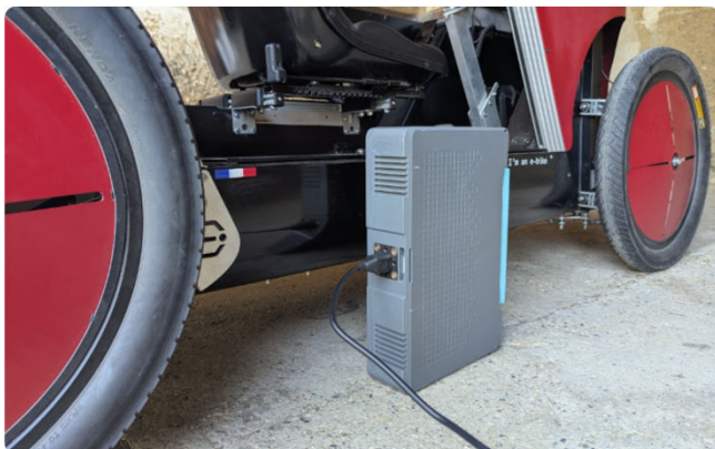
Recharge de la batterie déposée.
