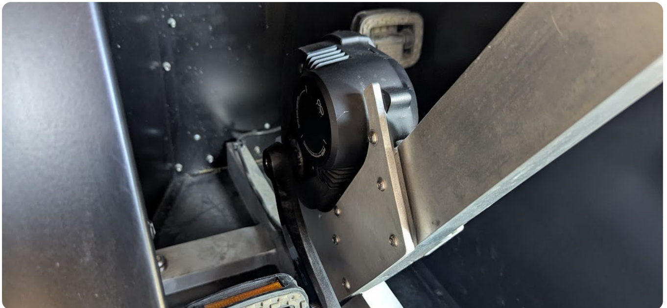
Le pédalier sans chaîne : moins de pièces d'usure, aucune chaîne à entretenir ni à retendre.
