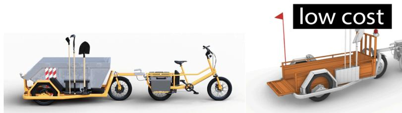
Le prototype 3 s'adresse aux artisans et familles. En plus d'offrir une surface de chargement très basse (30cm du sol) il doit également offrir une forte stabilité et de la sécurité. Il sera donc particulièrement adapté aux familles et aux utilisateurs peu à l'aise avec la conduite de vélo cargo en ville. Ces 3 prototypes, homologués en catégorie VAE, seront accessibles à tous, sans aucun permis de conduire et aident à démocratiser l'usage des mobilité douce en ville.
