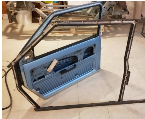
Réalisation des charnières et pose de la porte sur le cadre
