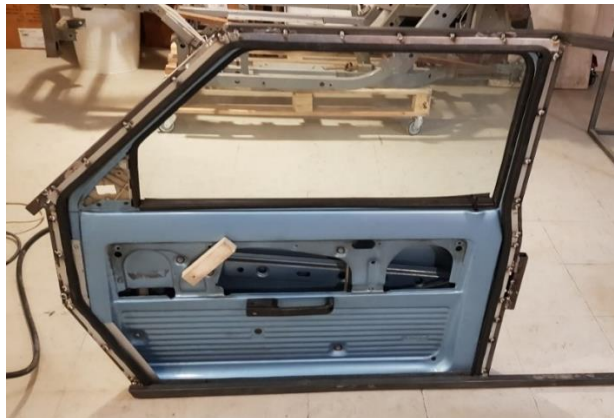
Réalisation des portées de joint et pose
