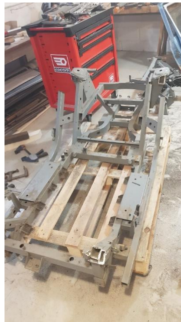
restes du châssis après tronçonnage
