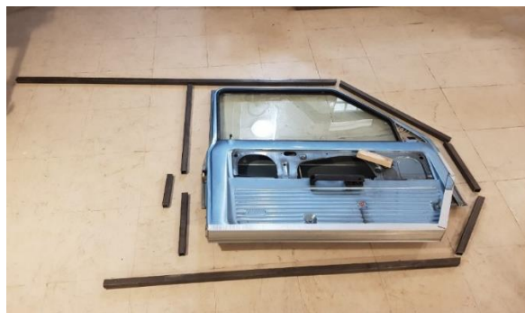
Découpe des tubes nécessaires à la fabrication du tour de porte
