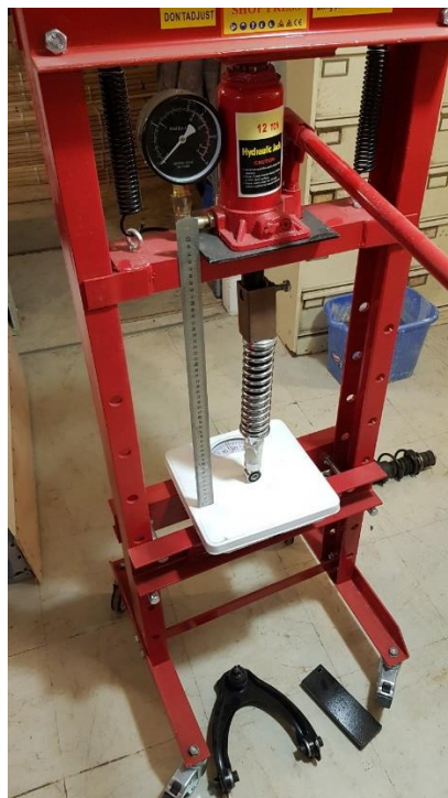
Dispositif pour mesurer la raideur du combiné (Mesure de la charge sous presse avec pèse personne et déflexion par lecture sur réglet)
