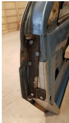
Réalisation des charnières et pose de la porte sur le cadre
