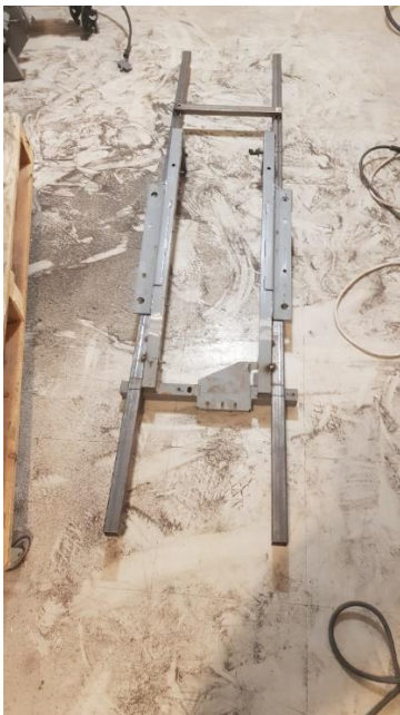
Structure de siège après extraction
